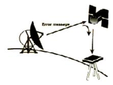
Esto significa que la señal que recibe un receptor de GPS no es solamente un Código Pseudo Aleatorio con fines de timing. También contiene un mensaje de navegación con información sobre la órbita exacta del satélite
