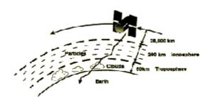
Hay un par de maneras de minimizar este tipo de error. Por un lado, podríamos predecir cual sería el error tipo de un día promedio. A esto se lo llama modelación y nos puede ayudar pero, por supuesto, las condiciones atmosféricas raramente se ajustan exactamente el promedio previsto.
